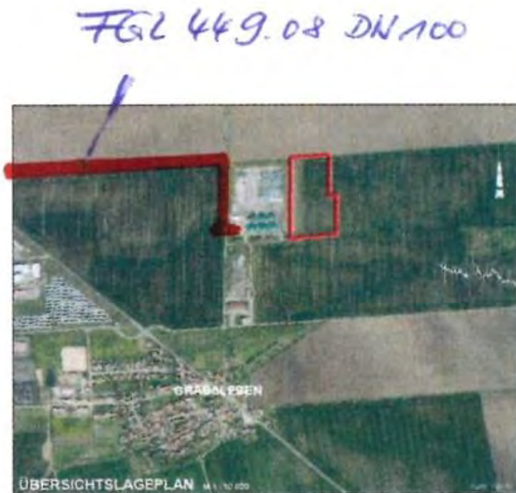
Abb. 5: Luftbildausschnitt mit nachrichtlicher Darstellung der bestehenden Ferngasleitung (FGL 449.08 DN 100). Östlich grenzen die bestehende Biogas-Anlage sowie das gekennzeichnete Erweiterungsgebiet an
