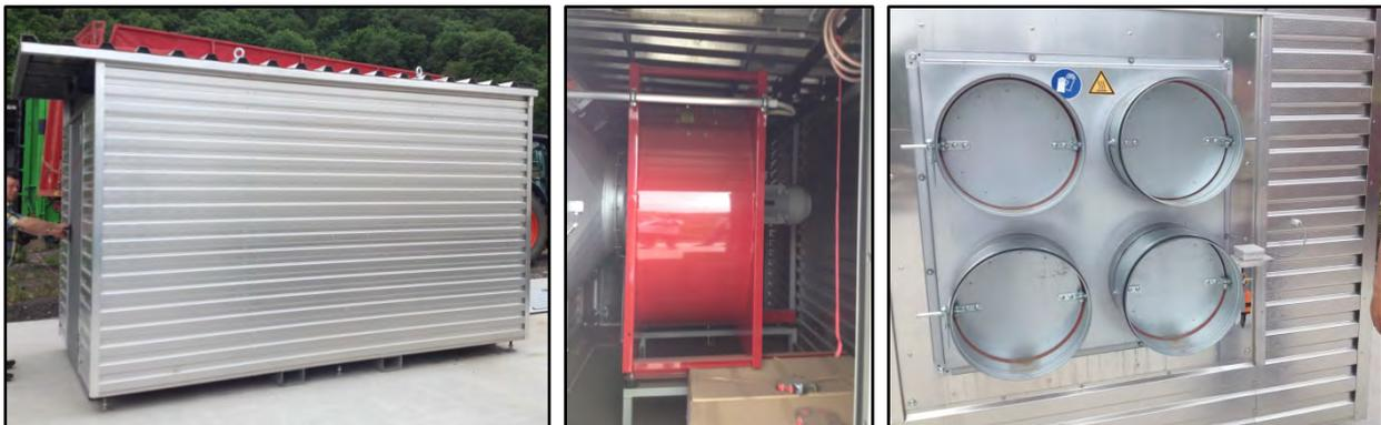
**Abbildung 4: Container Trockner - Ansicht Nord (l.), innen (m.), Anschlüsse West (r.)**
